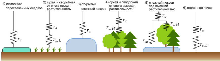
Рис. 3. Используемые при вычислении турбулентного потока влаги схемы аэродинамических сопротивлений для каждого из типов поверхности суши
