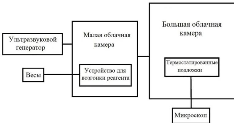
Рис. 1. Схема типовой установки
