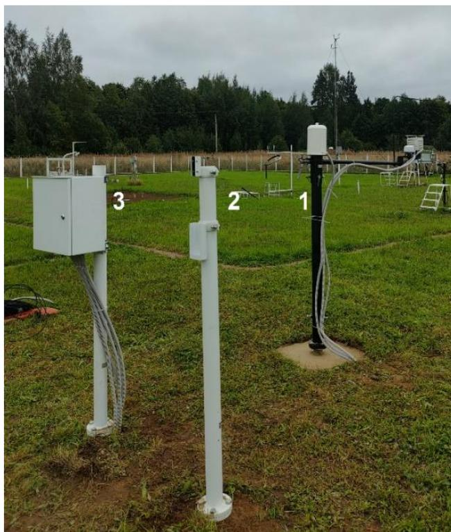
1 – стойка актинометрическая, 2 – стойка для специального корпуса,
