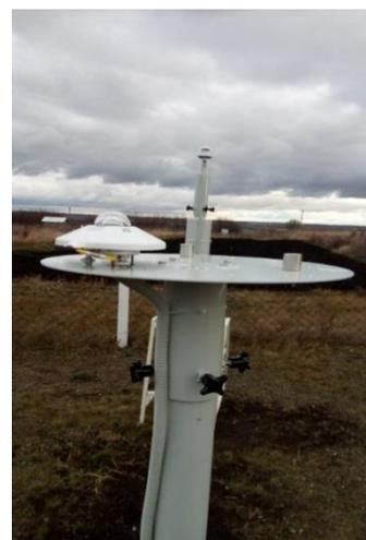
а) пиранометр СФ-06 с БЭИ; б) пиранометр СМР6 в составе АМК
