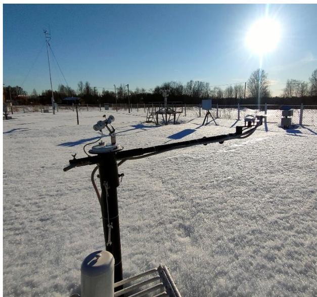
Рисунок 6 - Актинометрическое оборудование для проведения срочных наблюдений.
