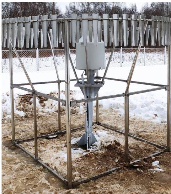
Рисунок 1.1 – Конструкция установочного комплекта датчика осадков #1 в собранном виде.
