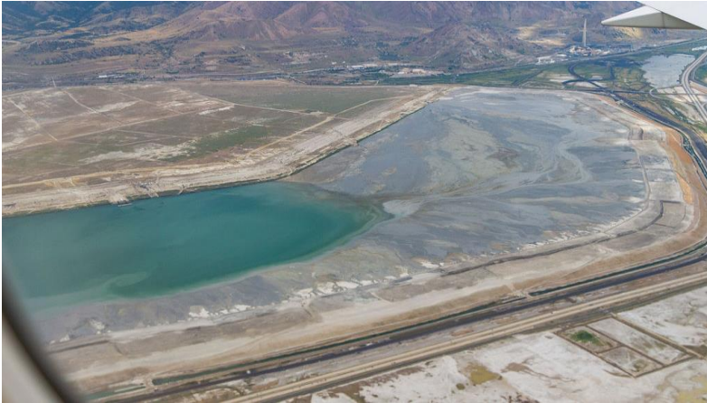
Рис. 2. Хвостохранилище предприятия Bingham Canyon Open Pit Copper Mine в штате Юта, США.
