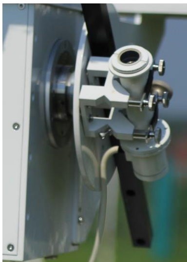
Рисунок 11 – Размещение на следящей системе актинометра (слева) и пиранометра (справа)
