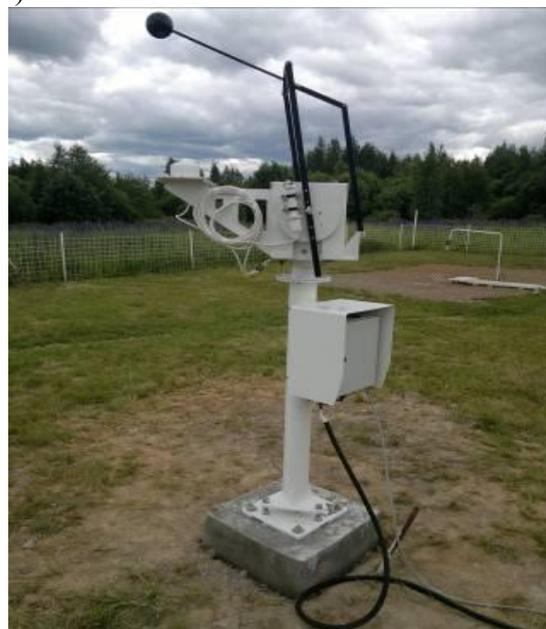
Рисунок 6. Примеры трекеров комплекса ААК (а) и АИК (б), установленных на метеорологической площадке.
