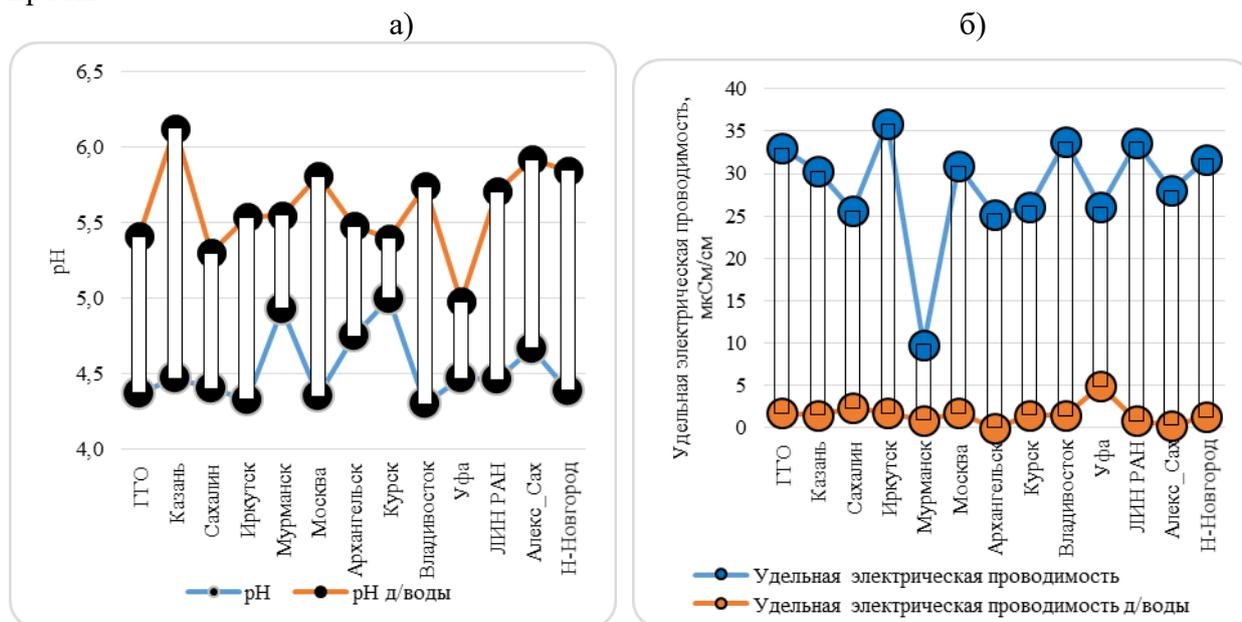
Рисунок 3 – Величина рН и удельной электрической проводимости дистиллированной воды и после разбавления контрольной пробы:
