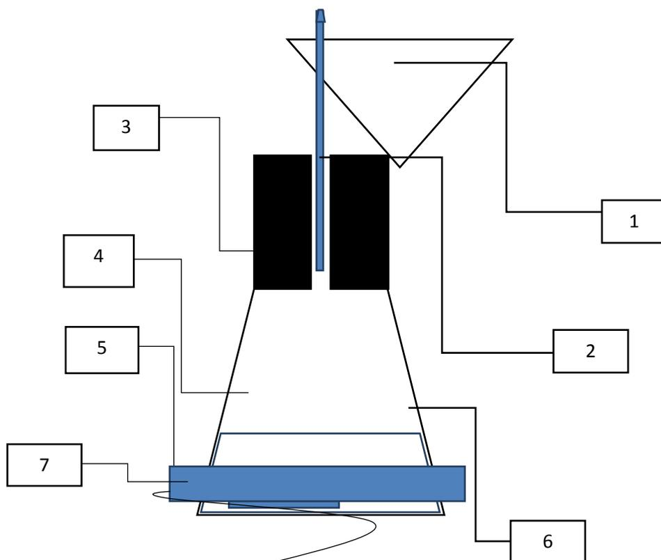
Рисунок-схема. 1— воронка; 2- стеклянная трубка; 3 — резиновая пробка с отверстием; 4 — стеклянная колба из термостойкого стекла вместимостью 500 см<sup>3</sup>; 5 — кипелки (капиллярные трубочки); 6 — дистиллированная вода; 7 — электроплитка.
