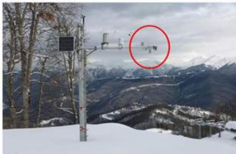
Рисунок 10.2 –Мачта АМК с установленным датчиком SR50A
