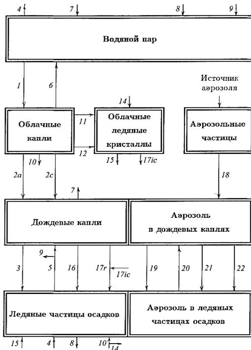
Рис. 4.1.1. Схема баланса субстанций в облаке с учетом аэрозоля
