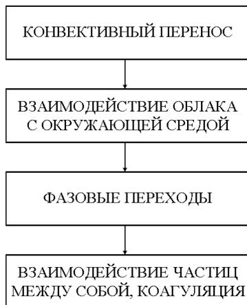
Рис. 1.5.2. Блок-схема программы расчета характеристик конвективного облака.
