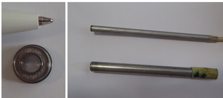
Рисунок 11. Подшипник для RM Young (слева), датчики температуры подстилающей поверхности «Тесей» ТСПТ 300 старой и новой модификаций (справа).
