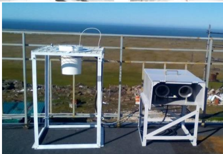
Рис. 2. Установка выносных блоков измерителей «Поле-2М» и «Электропроводность-2М»: а) на ГМО Тикси; б) на НИС «ЛБ мыс Баранова»; в) на метеостанции Диксон.
