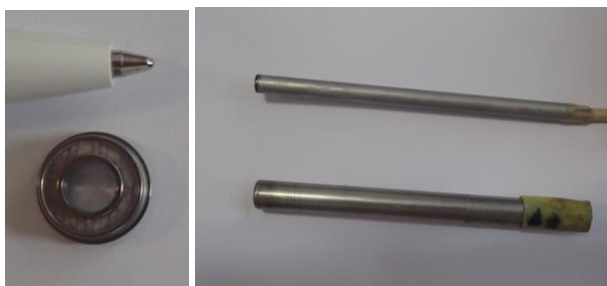
Рис. 10. Подшипник для RM Young (слева), датчики температуры подстилающей поверхности «Тесей» ТСПТ 300 старой и новой модификаций (справа).
