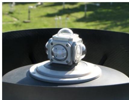
Рис. 1. Прибор Daylight Photometer Head Model 910GV фирмы PRC Krochman GmbH: а – внешний вид, б – блок датчиков.
