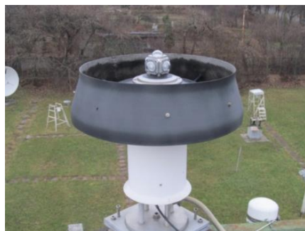
Рис. 1. Прибор Daylight Photometer Head Model 910GV фирмы PRC Krochman GmbH: а – внешний вид, б – блок датчиков.
