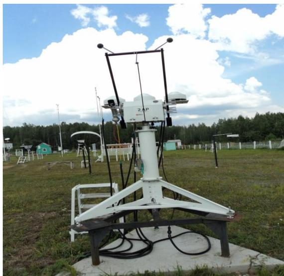
Рис. 3. Фрагмент метеорологической площадки Верхнее Дуброво с трекером ААК на переднем плане и с установками УАР на заднем плане.
