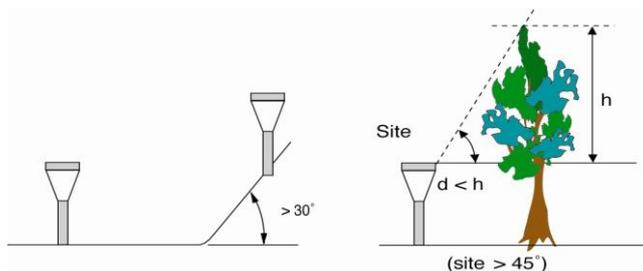
Рисунок А.4 – Место размещения осадкомера при классе 4
