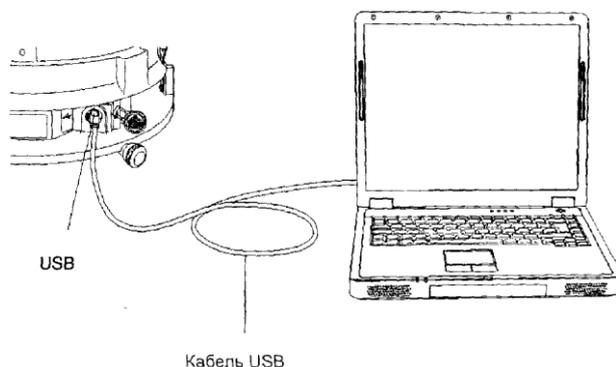
Рисунок В.1 – Подключение осадкомера ОТТ Pluvio<sup>2</sup> 200 к компьютеру через USB
