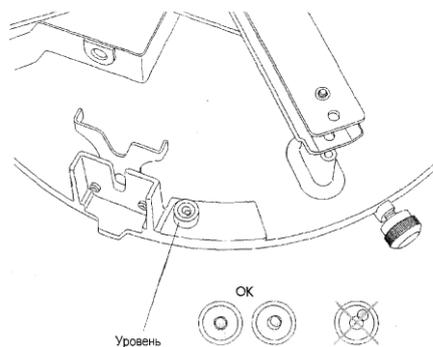
Рисунок Б.3 – Юстировка осадкомера ОТТ Pluvio<sup>2</sup> 200
