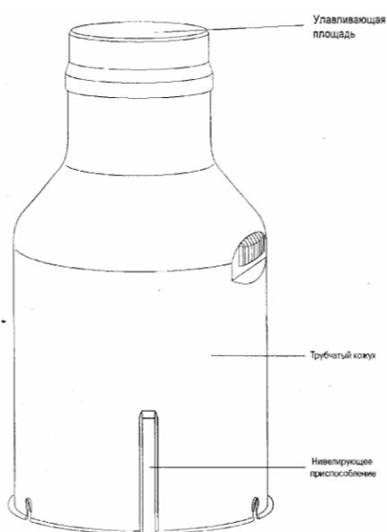
Рисунок 2 – Трубчатый (защитный) кожух осадкомера ОТТ Pluvio<sup>2</sup> 200
