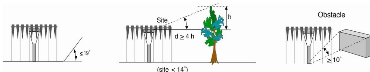
Рисунок А.1 – Место размещения осадкомера при классе 1
