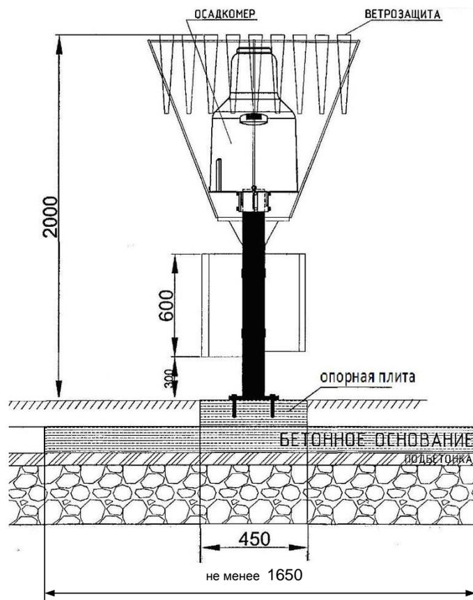
Рисунок Б.1 – Осадкомер ОТТ Pluvio<sup>2</sup> 200 с установочным столбом и опорной плитой (размеры указаны в миллиметрах)
