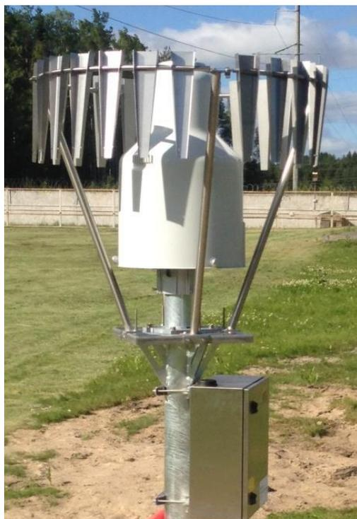
Рисунок 1 – Осадкомер ОТТ Pluvio<sup>2</sup> 200 в ветровой защите Альтера
