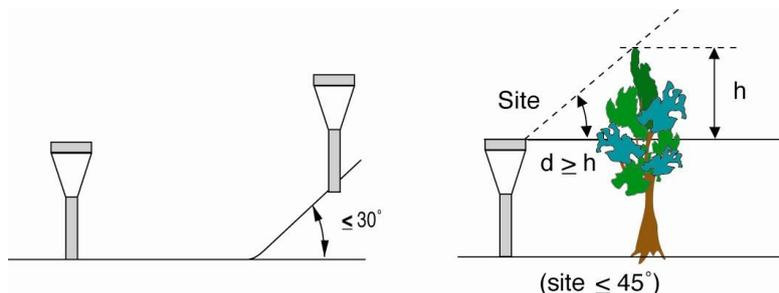
Рисунок А.3 – Место размещения осадкомера осадков при классе 3
