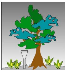
Рисунок А.5 – Место размещения осадкомера при классе 5
