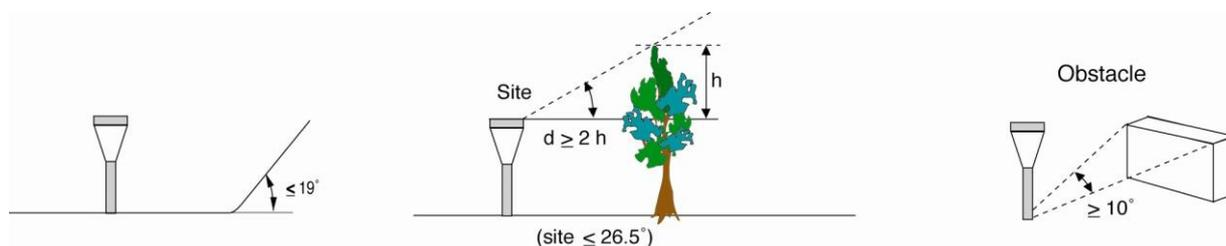
Рисунок А.2 – Место размещения осадкомера при классе 2
