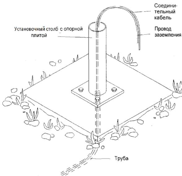
Рисунок Б.2 – Место установки, подготовленное для монтажа осадкомера ОТТ Pluvio<sup>2</sup> 200
