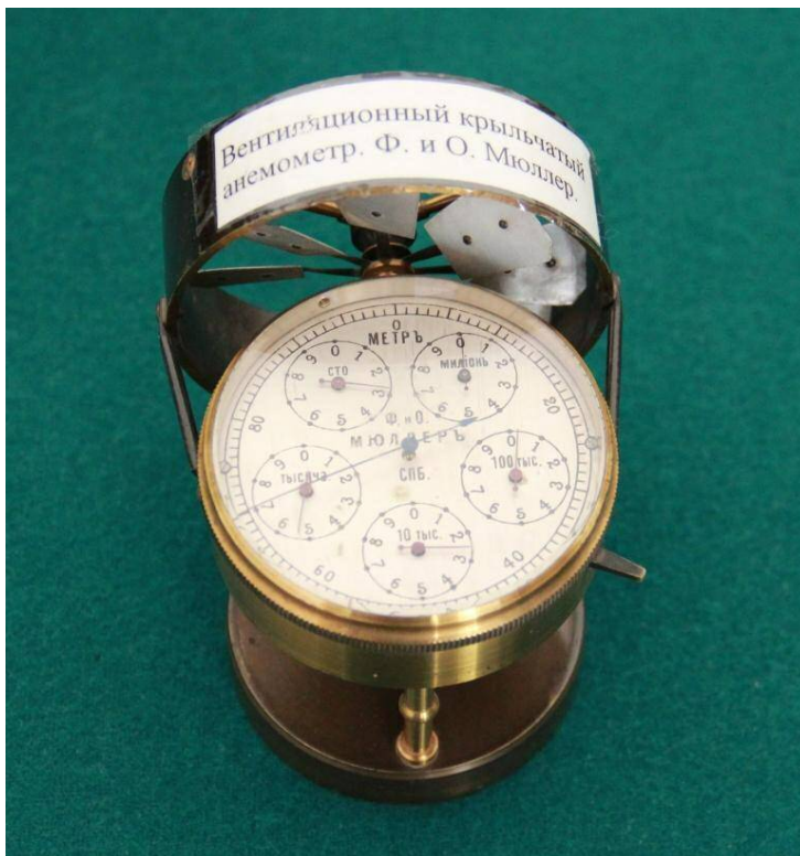
Вентиляционный анемометр. Предназначен для измерения скорости ветра.
