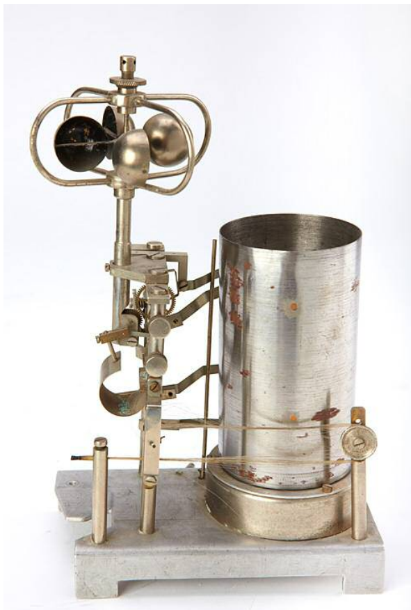
Змейковый метеорограф В. В. Кузнецова. Предназначен для регистрации данных о скорости ветра и температуре и влажности воздуха. (представлена внутренняя часть прибора).
