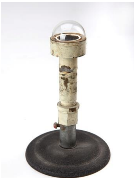
Термоэлектрический пиранометр Савинова. Опытный образец.
