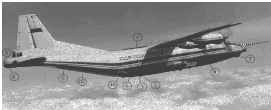
Рис. 1. Схема размещения оборудования на самолете–лаборатории АН-12 «Циклон» №11530
