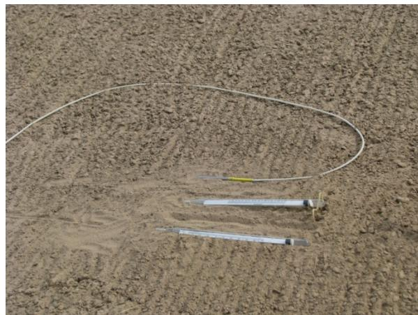
Рисунок 9.2 – Установка датчика температуры подстилающей поверхности
