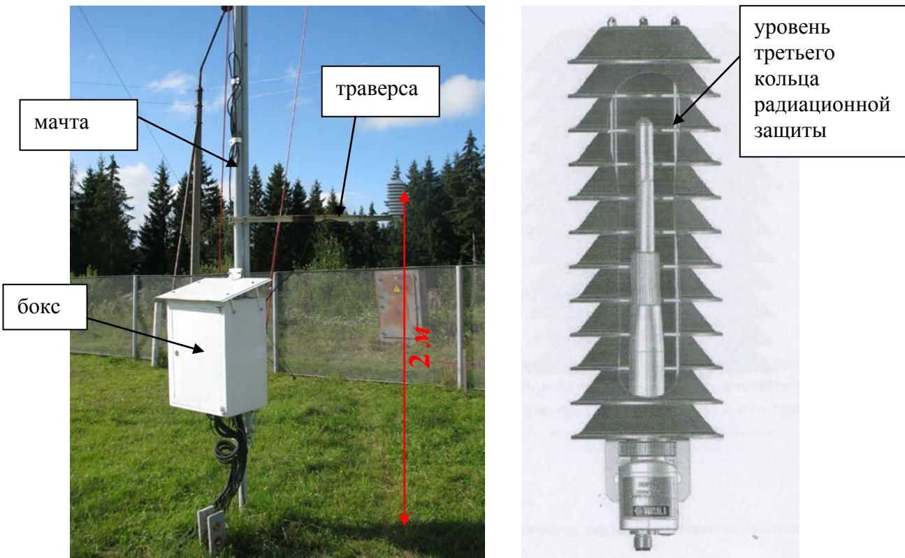
Рисунок 8.3 – Мачта АМК с установленной радиационной защитой датчика температуры и влажности
